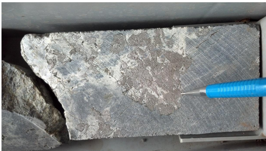
Figura 11 – Testemunho de sondagem que expõe zona mineralizada na metagrauvaca (GRV).
