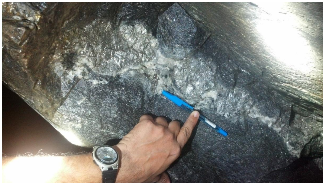
Figura 10 – Bolsões de arsenopirita estirados ao longo da foliação da metagrauvacas (GRV).
